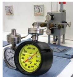
Prueba de filtraciones del puerto de llenado.
